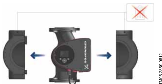
Fig. 3 Installation des coquilles d'isolation sur le circulateur
