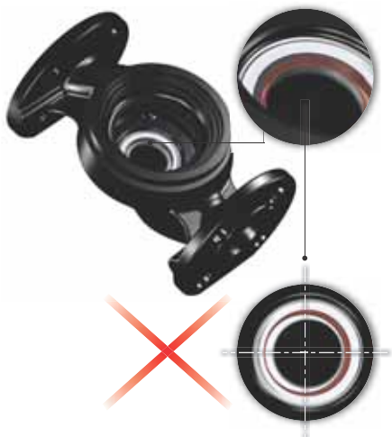
Fig. 11 Sistema de sellado centrado incorrectamente
