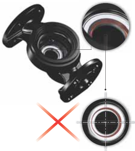
Fig. 11 Système de garniture mal centré
